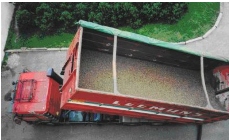
Foto 3 Kergkruusa transpordiks kasutatakse spetsiaalset puhuriga varustatud autot. Puhuri töökõrgus on 20-22 m, kõrgemate objektide puhul tuleb kasutada kraanat ja spetsiaalset tõstekasti.
